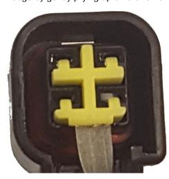
REMOVE LOCKING WEDGE BY GENTLY PRYING UP ON THE TAB AS SHOWN
